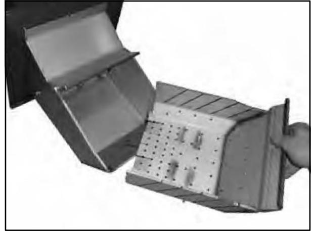
Herausnahme der Verbrennungskammer aus dem Brenner
