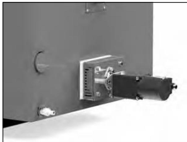
Hinterer Kesselbereich mit Getriebemotor für Entaschung
