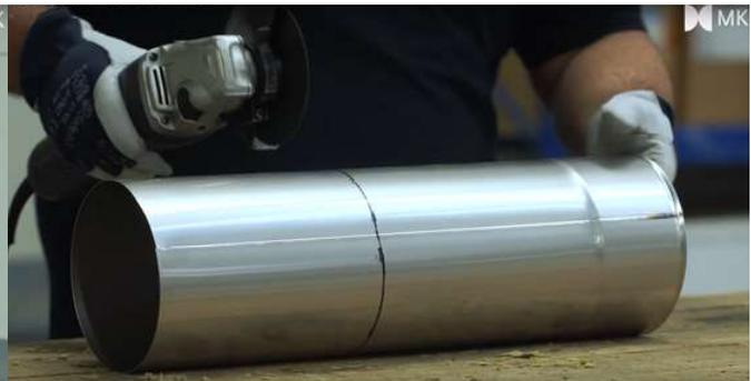
4. Nach erfolgter Kürzung werden die Rohrenden beider Rohre entgratet sowie glatt geschliffen.
