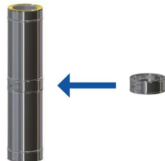
Nach dem Zusammenstecken der Elemente wird die Verbindung zusätzlich mit einem Klemmband gesichert.
