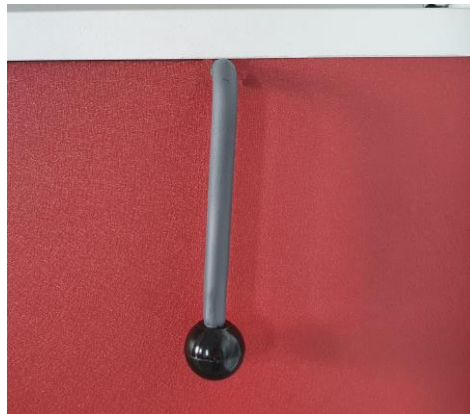
Abbildung 7: Kurzschlussklappenhebel in geöffneter Stellung.
