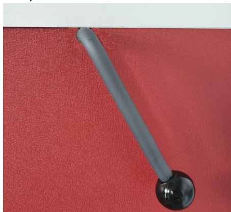
Abbildung 8: Kurzschlussklappenhebel in geschlossener Stellung.
