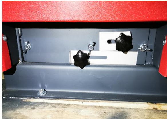
Abbildung 9: Lage der Klappen für die Sekundärluftzufuhr
