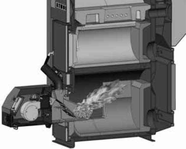
Die Flammenlänge muss vor der Kessellückwand 1 - 3 cm enden.
