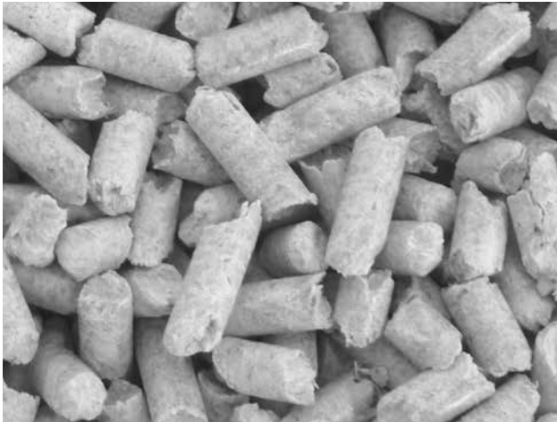
Hochwertige Holzpellets – Weißpellets ohne Schwarzpunkte (Rinde)
