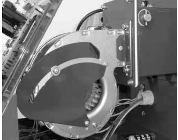
Brenner-Ventilator mit Luftklappe. Die Öffnung der Klappe verkürzt die Flammenlänge.
