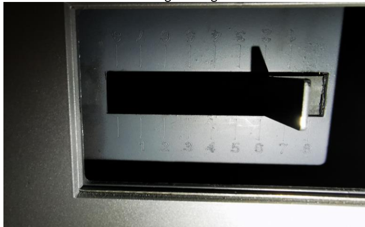
Abbildung 10: Einstellung der Primärluftmenge
