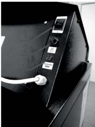
Bild 17. 1 – Hauptschalter, 2 – Havarie Thermostat, 3 – Sicherung (F6,3A)
