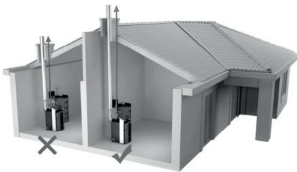
Bild 3. Richtige und falsche Kaminparameter des Kesselanschlusses SLX
