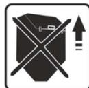
**Der Behälterdeckel muss im Betrieb immer geschlossen bleiben, um einem möglichen Rückbrand vorzubeugen!**
