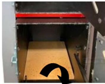
2. Öffnen Sie die Brennraumtür und nehmen Sie die Keramikplatte heraus.
