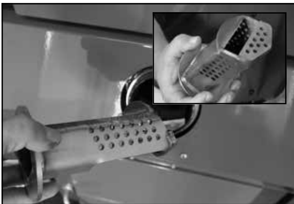
Die Zünd- und Blindkammer herausnehmen
