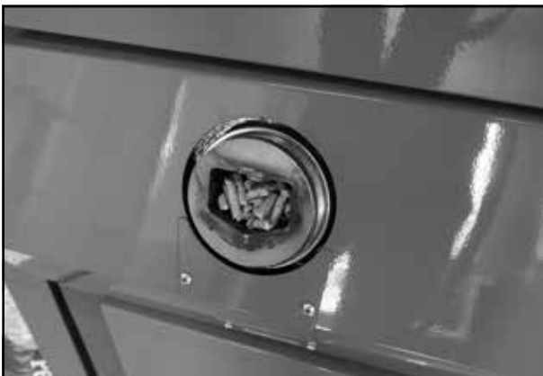
Die Menge von Pellets zur Entzündung in der Kammer der automatischen Zündung
