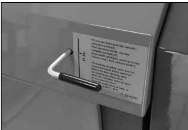
Anheizklappe geschlossen – Zugstange eingesteckt
