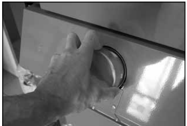
Den Deckel der automatischen Zündung fest anziehen
