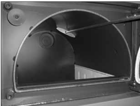
Die obere Nachlegekammer mit dem Schaber zu reinigen
