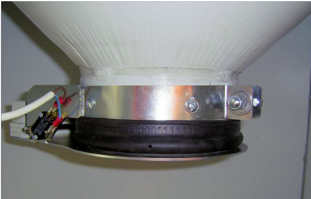
Abb. Nr. 4 Die Schleuseklappe in geschlossener Position
