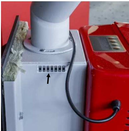
Abbildung 14 Position der Sicherheitsaufkleber auf dem Brenner
