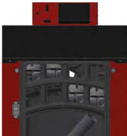
Abbildung 9 Platzierung der Stahlwolle in den Rauchgaskanälen.
