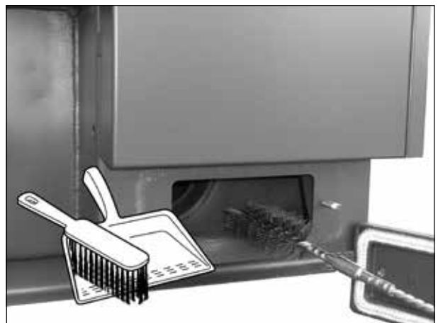
Vorführung der Reinigung des Rauchkanals mit Drahtbürste.
