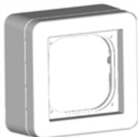
Montageset bestehend aus Einfachrahmen und Aufputzrahmen. 40mm Gesamthöhe für 55mm Einsatz bietet ausreichend Platz für Sensoren mit 230V Spannungsversorgung wie °C-Lite Smart oder Room Sensor Smart. Kunststoffrahmen weiß RAL9003, 80mm x 80mm matte erodierte Oberfläche mit UV-Schutz.
