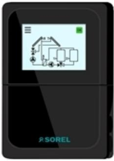
Der TDC Smart Prime ist ein Temperatur-Differenz-Regler für komplexe Solarthermie-Systeme mit bis zu vier Speichern. Über digitale Durchflusssensoren kann eine präzise Wärmemengenzählung vorgenommen werden. PWM-Eingänge ermöglichen die bidirektionale Kommunikation mit iPWM-kompatiblen Pumpen, um den korrekten Anlagenbetrieb sicherzustellen. Ein Steckplatz für Zusatzplatinen bietet eine flexible Erweiterbarkeit für zusätzliche I/Os oder Kommunikationsschnittstellen.
