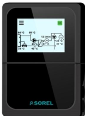
Der FWC Smart Advance ist ein Regler für zentrale Frischwasserstationen mit drehzahl geregelter Hocheffizienzpumpe und diversen einstellbaren Zusatzfunktionen. Die Durchflussmessung kann nach Wunsch über verschiedene Sensortypen erfolgen. Mehrere Regler können als Kaskade zusammengefügt werden und optional per Bus kommunizieren oder Schrittmotoren ansteuern. PWM-Eingänge ermöglichen die bidirektionale Kommunikation mit iPWM-kompatiblen Pumpen, um den korrekten Anlagenbetrieb sicherzustellen.
