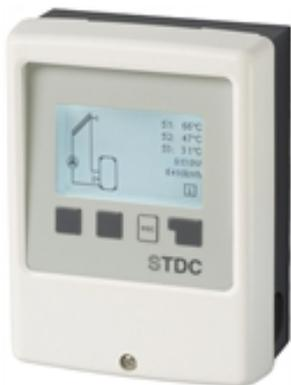
„Small“ Temperatur Differenz Controller für einfache Systeme. Für 9 Solar-, Speicher- und Feststoffkesselsysteme. Der Regler kann mit oder ohne Drehzahlregelung, 0-10V / PWM-Ausgängen oder beidem ausgestattet werden.
