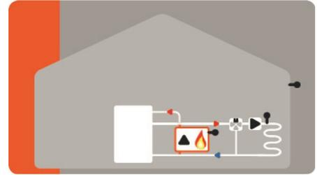
Kombispeicher oder Pufferspeicher mit gemischtem Heizkreis mit Zusatzfunktion Brenner und Kesselpumpe.
