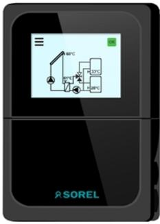
Der TDC Smart Advance ist ein Temperatur-Differenz-Regler für größere Solarthermie-Systeme. Zusätzlich zu den 39 vordefinierten Hydraulikschemata können weitere Funktionen flexibel auf freie Schaltausgänge belegt werden. Über digitale Durchflusssensoren kann eine präzisere Wärmemengenzählung vorgenommen werden.
