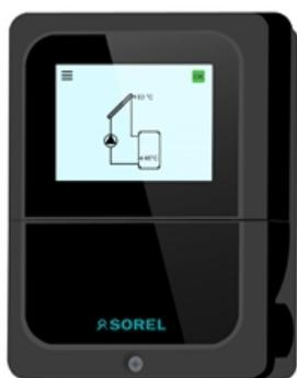
Der TDC Smart Basic ist ein Regler für einfache Solarthermie-Systeme, Kaminöfen oder allgemeine Temperaturdifferenz-Funktionen, die eine einzelnen Pumpe oder ein Ventil intelligent regeln. In Solaranlagen sorgt er z.B. bei ausreichender Temperaturdifferenz zwischen Sonnenkollektor und Wärmespeicher durch die Drehzahlregelung der Solarpumpe für die effiziente Speicherbeladung bis zur einstellbaren Maximaltemperatur.
