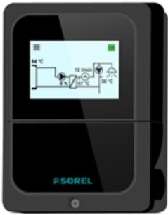
Der FWC Smart Compact ist ein Regler für zentrale Frischwasserstationen mit drehzahl geregelter Hocheffizienzpumpe und optionaler Zirkulationsregelung. Die Durchflussmessung kann nach Wunsch über verschiedene Sensortypen erfolgen. Mehrere Regler können als Kaskade zusammengefügt werden und optional per Bus kommunizieren. Ein PWM-Eingang ermöglicht die bidirektionale Kommunikation mit einer iPWM-kompatiblen Pumpe, um den korrekten Anlagenbetrieb sicherzustellen.
