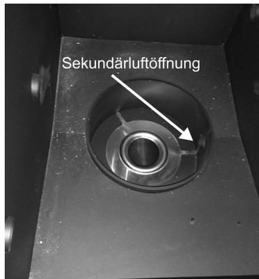
Abbildung 14: Lage der Sekundärluftöffnung
