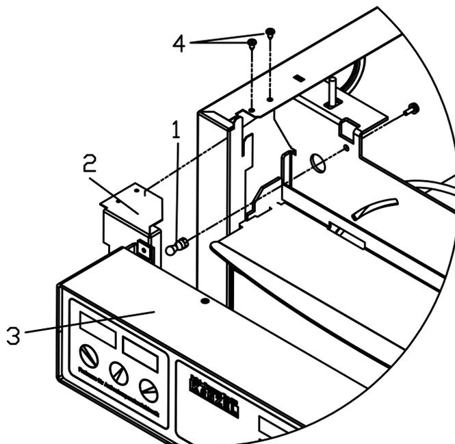
Abbildung 2: Die Schaltfeldmontage Typ HV–RL
