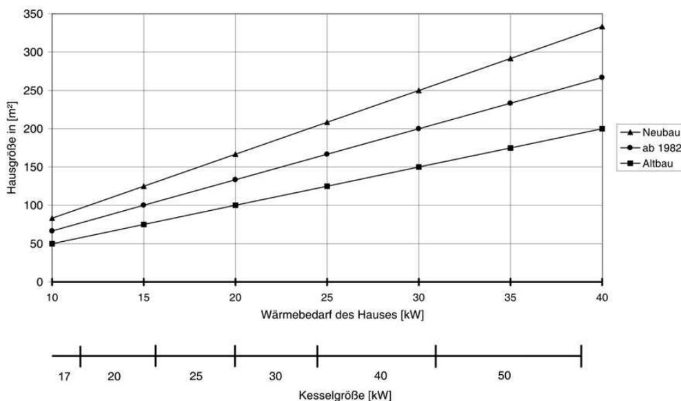
Abbildung 17: Auslegung der Kesselgröße
