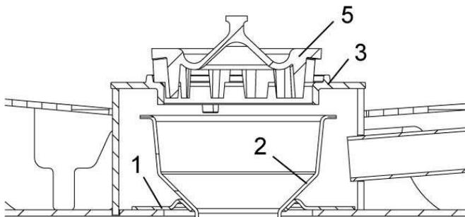
Abbildung 8: Der Turbobrenner im Schnitt
