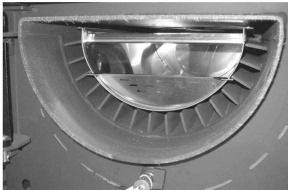
Abbildung 13: richtige Lage der Brennkammerschale
