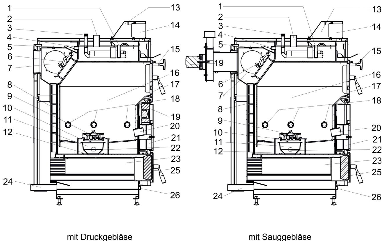
**Abbildung 6: Der Holzvergaser-Heizkessel**
