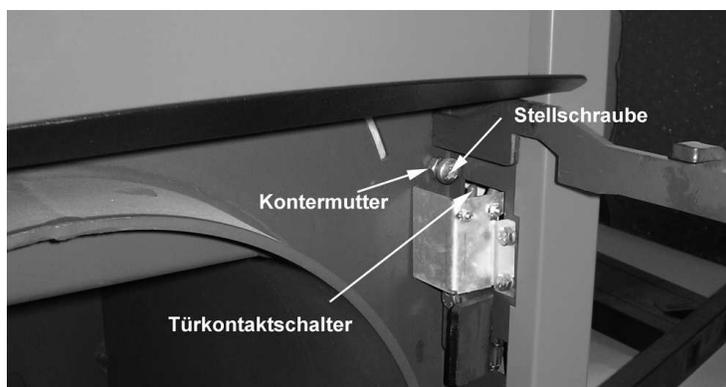
Abbildung 10: Das Anheizklappengestänge
